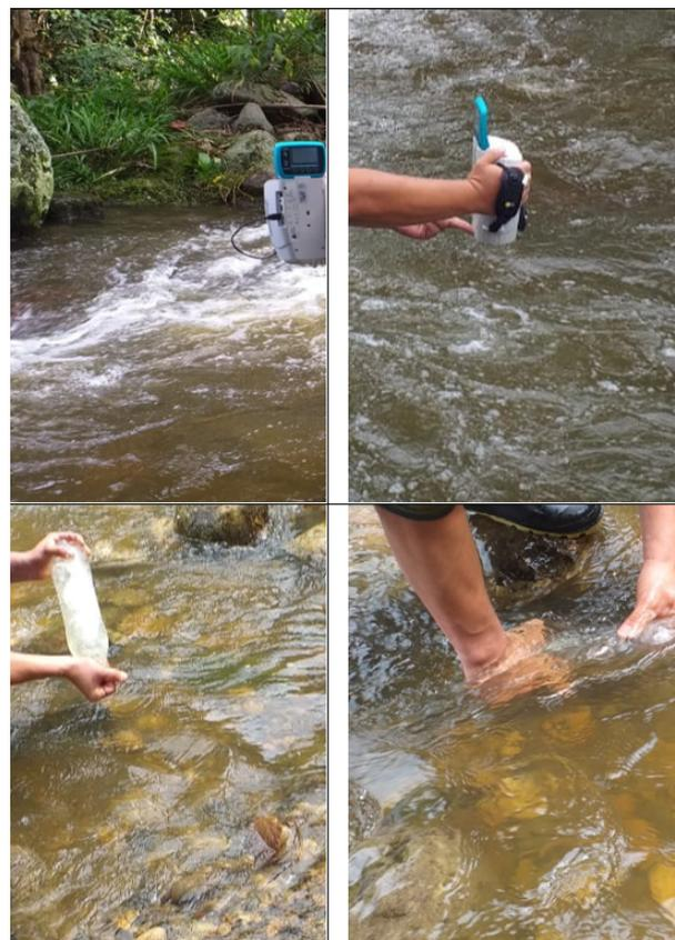
Figura 2: Toma de muestras de agua y datos espectrales, en la cuenca del río Cuja, utilizando el espectroradiómetro Hand Held-2, en los municipios de Pasca y Arbeláez
