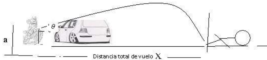
Fig. 1. Se muestra la posible colisión de un motociclista con un auto. El motociclista sale disparado en movimiento parabólico en un ángulo teta ( \theta ), recorriendo una distancia total X .
