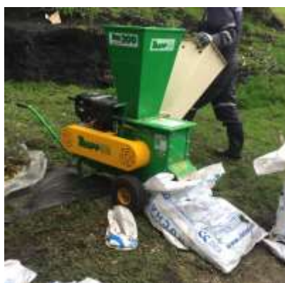
Fig. 2. Trituradora comercial “Trapp 300” usada para triturar y empacar las muestras in situ .
