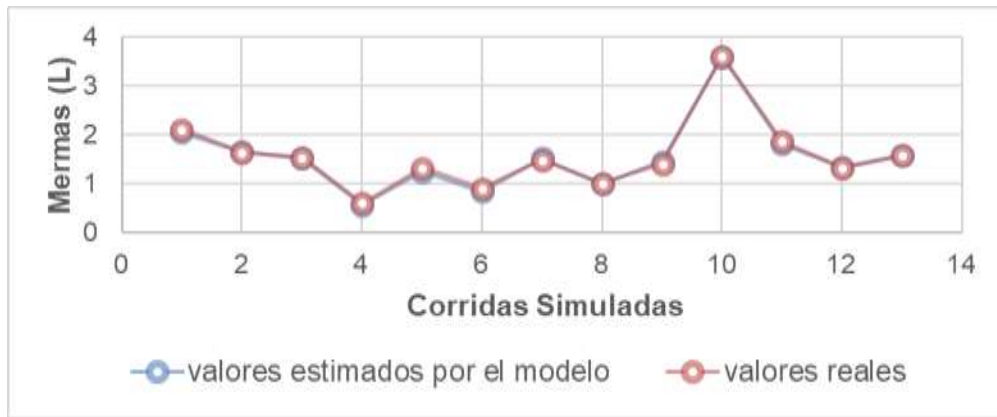
Fig. 1. Comparación entre los valores reales y predichos para el modelo de red neuronal (6-4-4-1).
