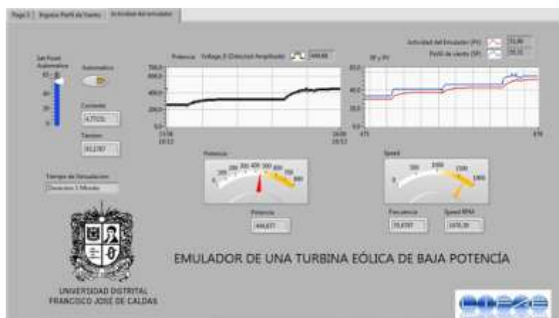
Fig. 9. Comportamiento del emulador durante la prueba en modo manual según la curva de potencia dada por el fabricante de la turbina elegida.
