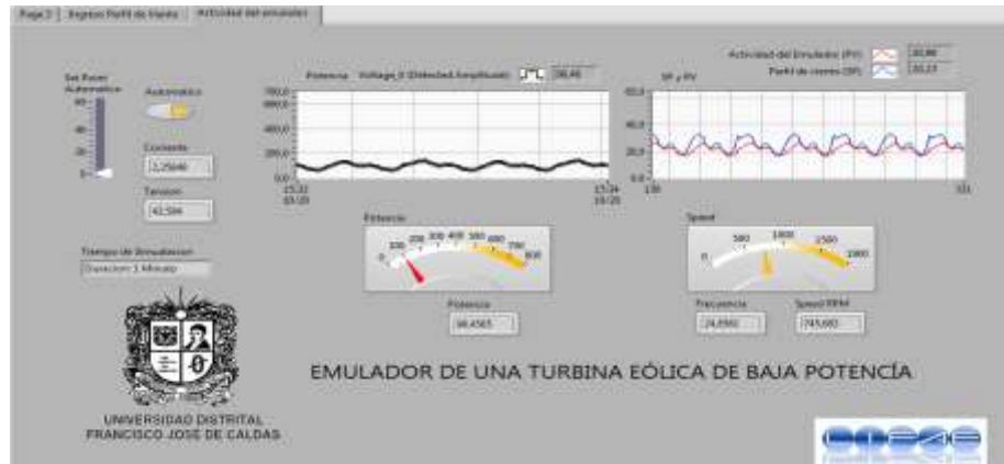
Fig. 11. Comportamiento del emulador, reproduciendo el perfil de viento de la Guajira y simulándolo con un tiempo de 1 minuto.
