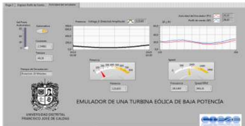
Fig. 12. Comportamiento del emulador, reproduciendo el perfil de viento de la Guajira y simulándolo con un tiempo de 10 minutos.
