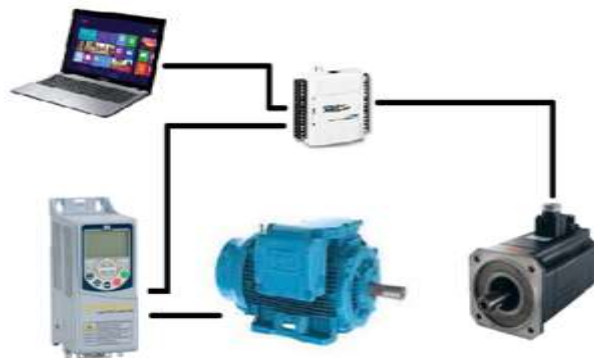
Fig. 2. Disposición de equipos del emulador de turbina eólica.
