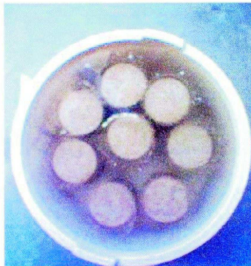
Gráfica 2. Exposición de probetas al ácido de batería.
