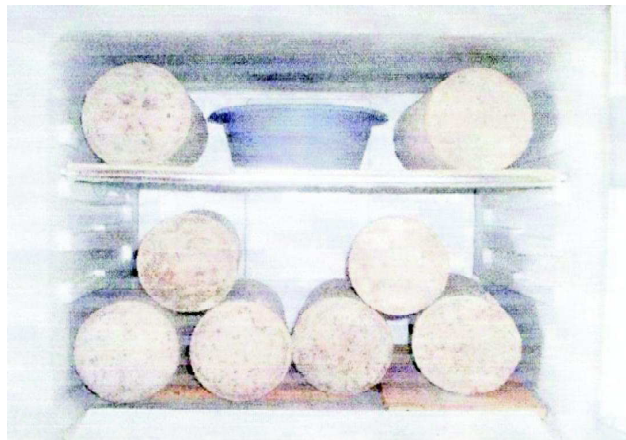
Gráfica 7. Exposición de las probetas ante ciclo hielo-deshielo.
