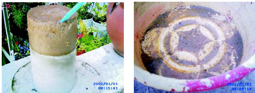
Gráfica 6. Afectación de las probetas ante el ácido muriático.
