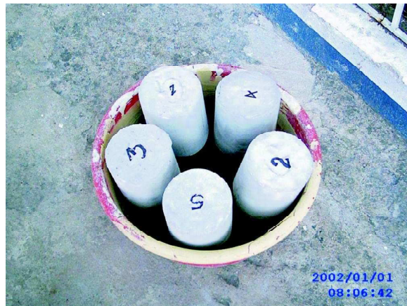
Gráfica 5. Exposición de probetas ante el ácido muriático.
