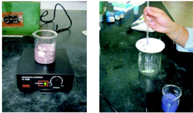
Fotografía 1. Agitación electromagnética y toma de manchas - Laboratorio de Suelos de la Facultad de Ingeniería. Uptc. 2008.
