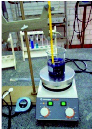
Fotografía 4. Agitación electromagnética calorifugada - Laboratorio Ambiental. Escuela Colombiana de Ingeniería. 2006.
