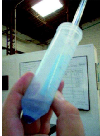
Fotografía 5. Líquido que sobrenada para la clasificación de la coloración. Método turbidimétrico. Laboratorio de Ambiental - Escuela Colombiana de Ingeniería. 2006.
