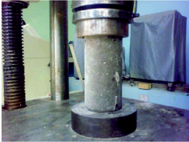
Fig. 22. Montaje del ensayo de resistencia a la compresión
