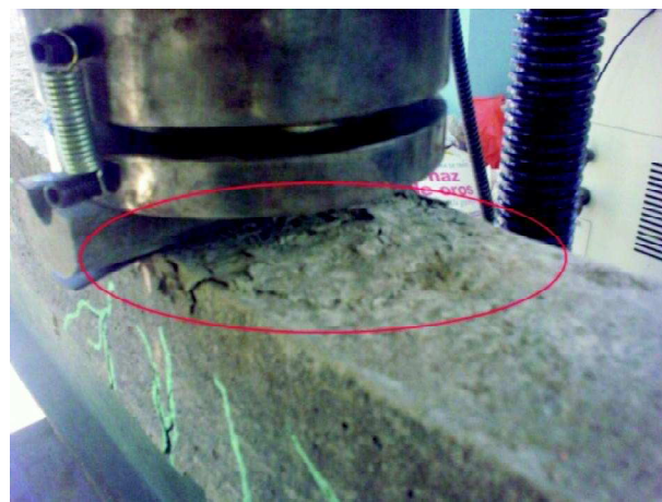
Fig. 35. Falla del concreto por esfuerzos de compresión
