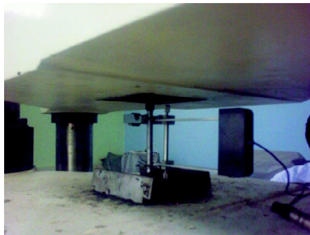
Fig. 26. Montaje del ensayo de tracción en barras de acero
