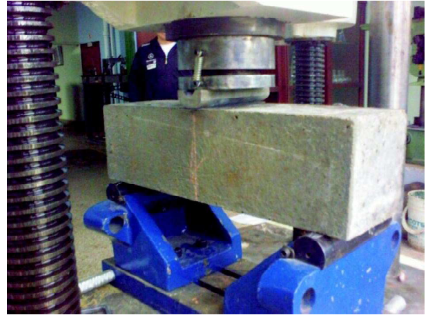
Fig. 23. Montaje del ensayo de módulo de rotura del concreto
