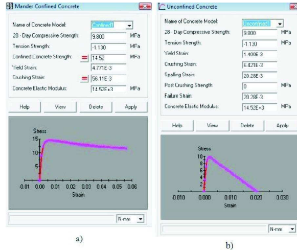
Fig. 55. Definición del concreto confinado e inconfinado en el Xtrac
