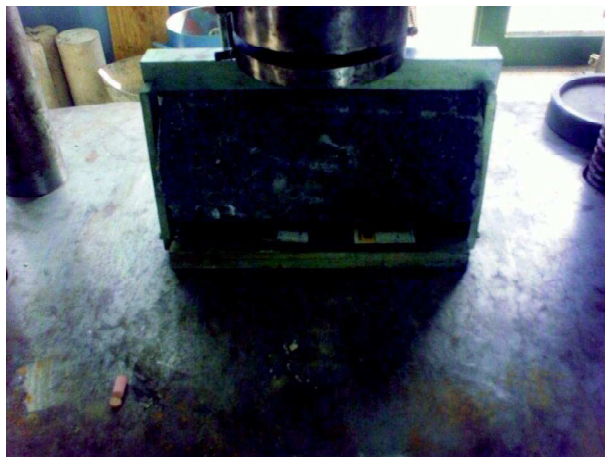
Fig. 24. Montaje del ensayo de tensión indirecta del concreto
