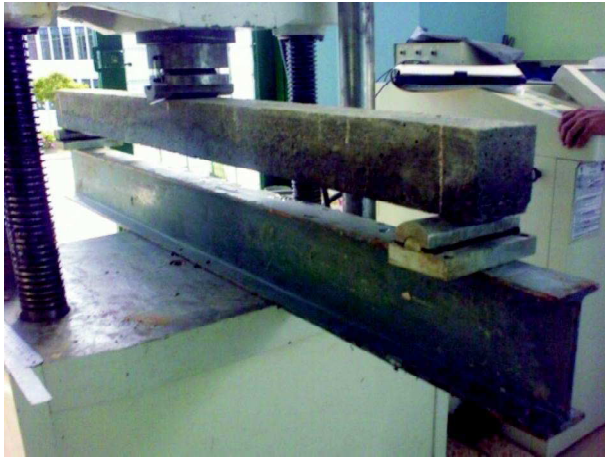
Fig. 27. Montaje del ensayo vigas reforzadas
