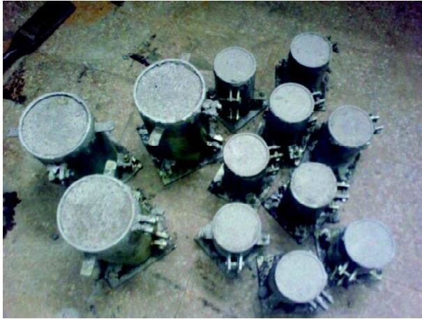
Fig. 20. Cilindros de concreto para resistencia a la compresión, relación de poisson y módulo de elasticidad
