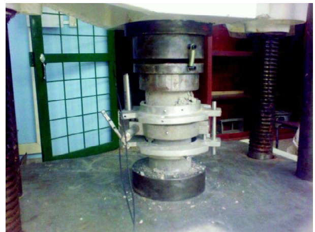
Fig. 25. Montaje del ensayo de módulo de elasticidad
