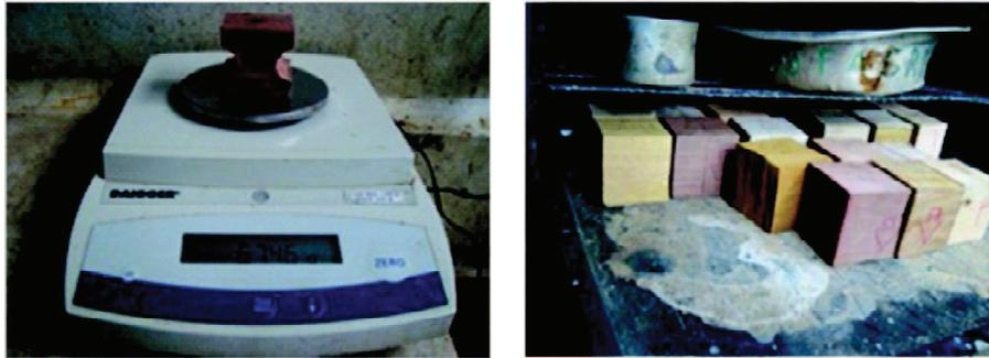
Figura 3. Pesaje de probeta (a), muestras en el horno eléctrico (b)
