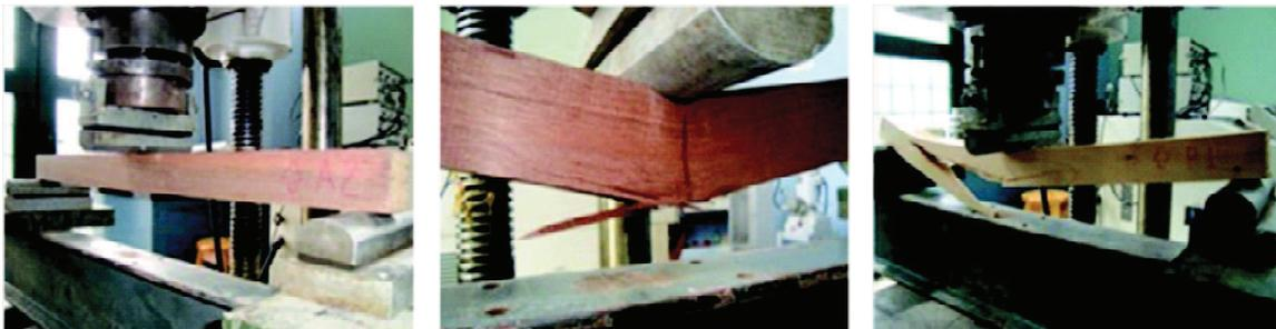
Figura 4. Ensayo de flexión (a), fallas por astillamiento (b), falla por quebramiento (c)
