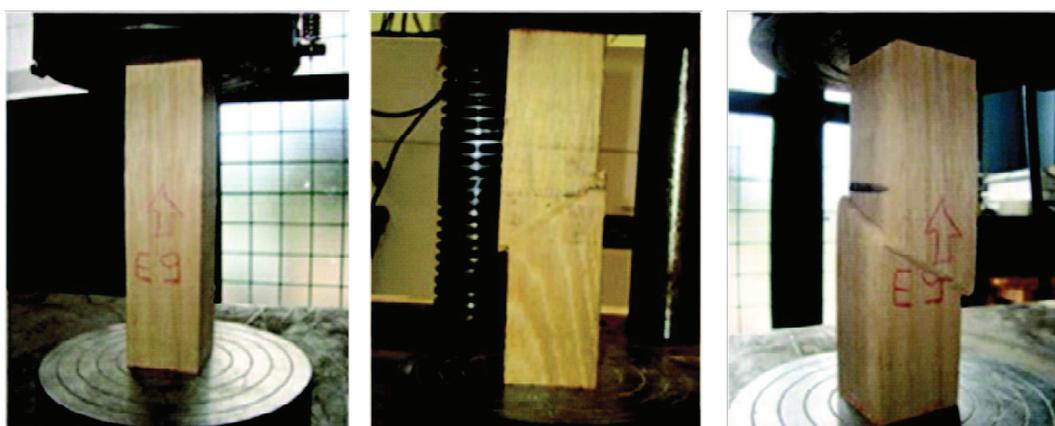
Figura 5. Ensayo de compresión paralela (a), Amarillo falla cuña (b), Eucalipto Falla cuña (c)
