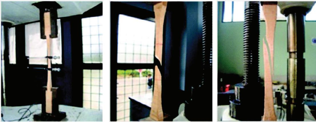
**Figura 7.** Ensayo de tracción (a), falla de Tracción simple (b), Falla fibra inclinada (c)
