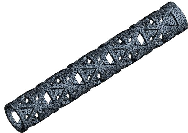
**Figura 2.** Discretización de los elementos del brazo del dron.
