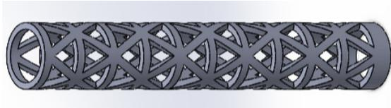
**Figura 1.** Geometría del brazo del dron con estructura Isogrid.
