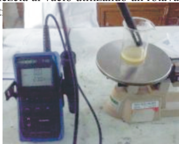
Figura 2. Montaje utilizado para controlar la acidez de la mezcla al agregarle HCl por medio de un pHmetro.
