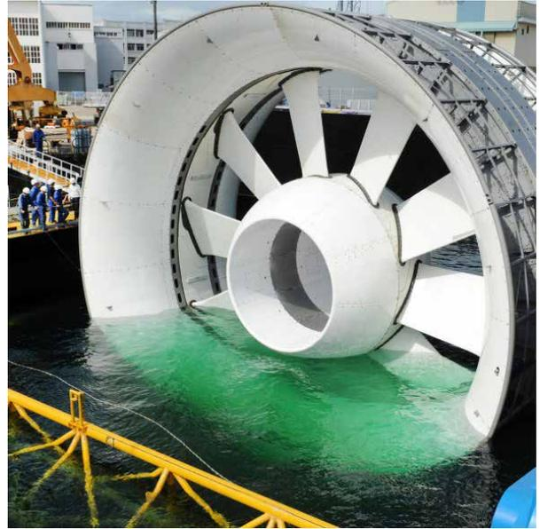
**Figura 2.** Sistema de generación de energía mareomotriz compuesto por turbina con eje horizontal, Francia (diámetro turbina: 16 metros, peso: 850 toneladas, potencia de turbina: 2,0 MW).
