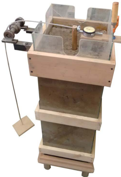
Figura 5. Montaje final del pilote, aparatos de medición y carga en el recipiente contenedor.
