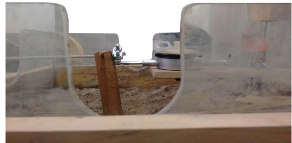
Figura 6. Deflexión lateral en uno de los pilotes ensayados.
