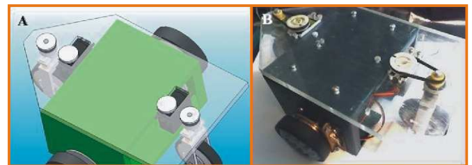
Figura 8. Mecanismo de direccionamiento. A. Representación en 3D. B. Implementación final. Fuente: Los autores.
