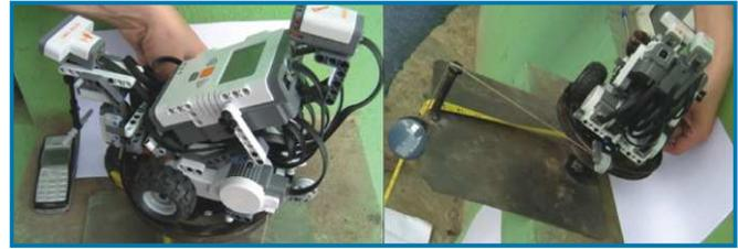
**Figura 9.** Determinación momento de inercia de TRIBOT-SP.
