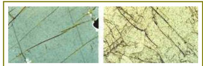
**Figura 5.** Mudanzas de aspecto y microfracturamiento de cristales de K-feldespato (Granito Verde Pavão). Izquierda (roca inalterada), color verde y fracturas rellenas de clorita y óxidos. Derecha (roca alterada), cambio de tonalidad a amarillo, aumento de la densidad de microfisuras y pérdida por lixiviación del material de relleno de las fisuras. Aumento 100X.
