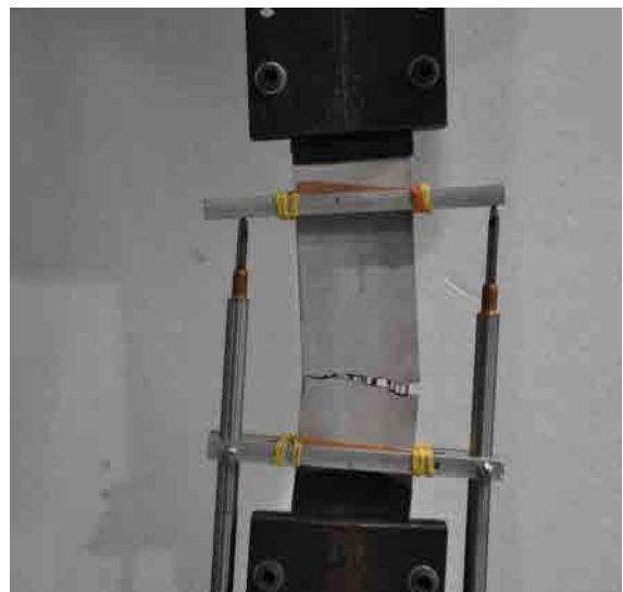
Figura 4. Ensayo de tracción directa del material compuesto
