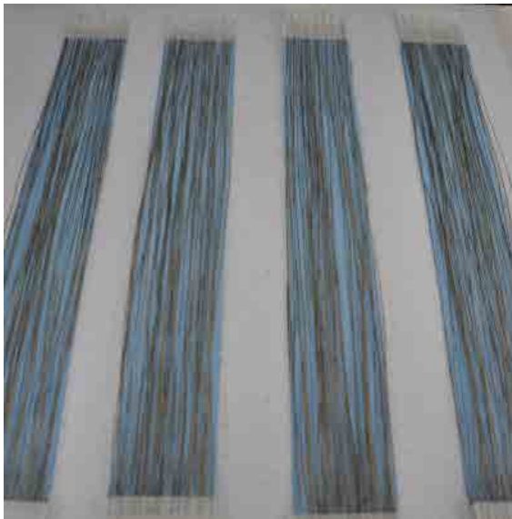
Figura 3. Fibras organizadas para colocar embebidas unidireccionalmente al compuesto
