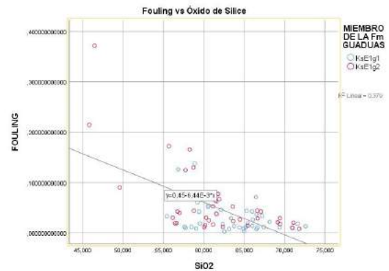
Figura 8. Gráfica de correlación inversa entre el Factor Fouling y el Óxido de Silice discriminando por miembro estratigráfico.
