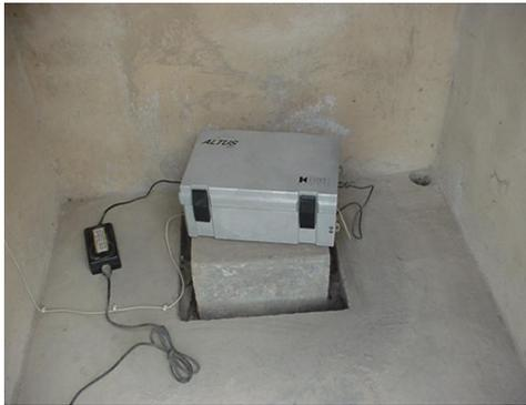
**Figura 5.** Acelerógrafo digital K-2\_ KINEMETRICS.
