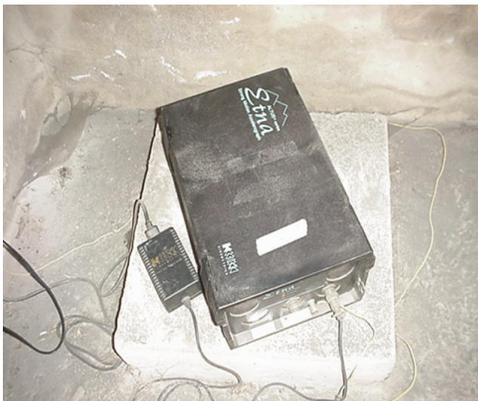
**Figura 6.** Acelerógrafo digital K-2\_ KINEMETRICS.
