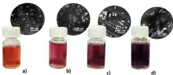
Figura 8. Cambio de color por agregación de AuNPs+Cis para concentraciones de As^{3+} a) 0, b) 1, c) 10, d) 100 \mu M respectivamente. Se muestran registro de microscopía de barrido de los agregados en función de la concentración.
