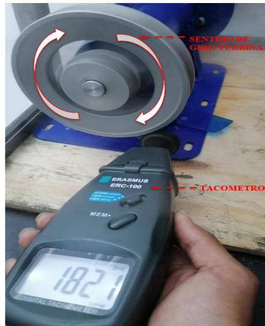
Figura 8. Mediciones de velocidad angular.
