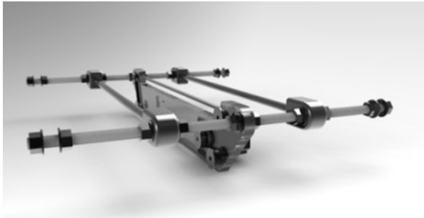
Figura 6. Actuador para movimiento en el eje y
