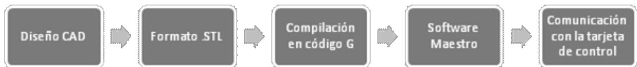
Figura 3. Diagrama de flujo de información para el control del sistema.
