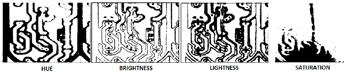
Figura 7. Comparación de los canales individuales según los modelos de color HSV y HSL
