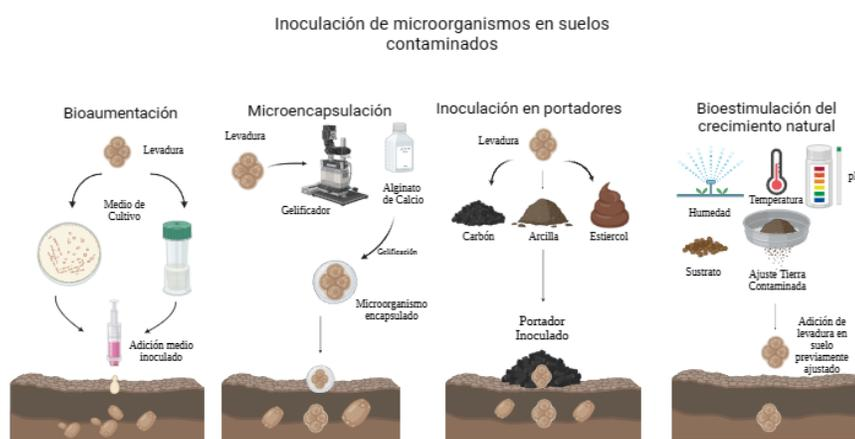
Nota: El gráfico ilustra de forma general, los mecanismos para introducir la levadura en el suelo, con el fin de mantener su viabilidad frente a otros organismos y que cumpla con el objetivo de degradar los pesticidas organofosforados presentes en el suelo.
